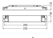
**Caractéristiques Osram LED driver Optotronica Fit 50 / 220-240V / 250 / D**
