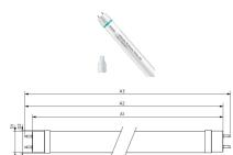
Technische Daten Philips LED Röhre 60cm | 6500K 8W - Master Value HO
