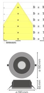
**Technische Daten Ledvance LED Downlight Performance DN155 Zigbee Weiß 14W 1600lm - 840 | 180mm - Ausschnitt 155mm**
