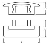
**Technische Daten Ledvance LED Streifen Abschlusskappe für Profil PF03**
